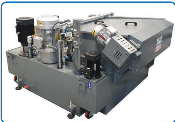
Filtration-System unter dem Lademagazin
